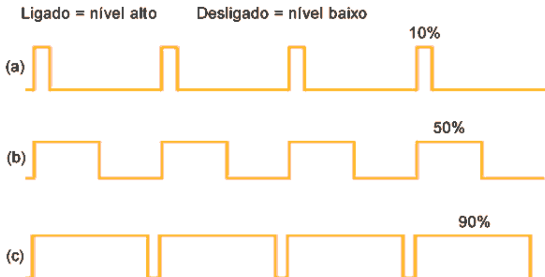
Fig. 7.0 - Exemplo conceitual de PWM com 10%, 50% e 90% de ciclo ativo.
